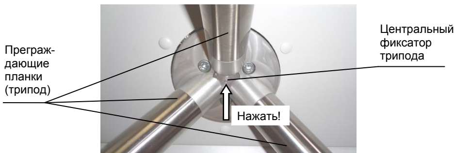
Рис.3 Место расположения центрального фиксатора трипода
